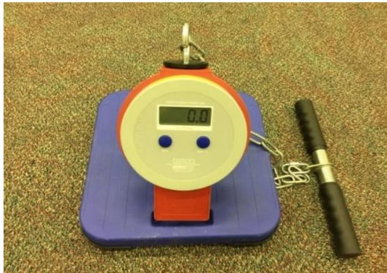
Gambar 3.3 *leg dynamometer*
